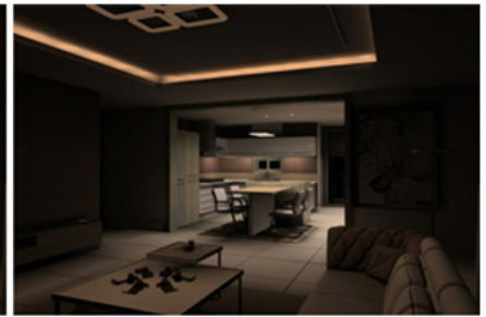
코브, 거실등 : 3500K, 전반조도 150lx 조리대, 간이조리대, 보조등 : 4500K, 식탁면조도 400lx 거실에서 본 주방이미지
