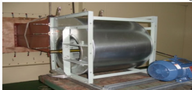
토출 챔버 구성 - 챔버 내 복합 노즐 (Outlet chamber setup-Multiple nozzle in chamber)
