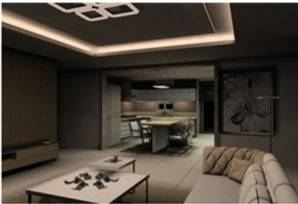
거실등, 코브(TV시청모드) : 4500K, 전반조도 200lx 조리대, 간이조리대, 주방보조등 : 5500K, 식탁면조도 400lx 거실에 채실자가 TV시청을 하고 있을 때 거실 모드 유지
