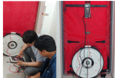
3) 팬 및 측정기기 설치
